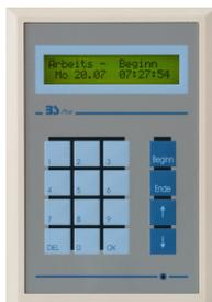
Die 3S-Plus Terminals mit der 16er-Tastatur bieten mehr Funktionalität als nur eine reine Zeiterfassung. Die übersichtliche Tastatur ermöglicht die einfache Eingabe numerischer Daten sowie das Scrollen und Auswählen aus verschiedenen Listen. Das große 2 x 20 Zeichen Display erlaubt eine schnelle visuelle Erfassung der Informationen.
